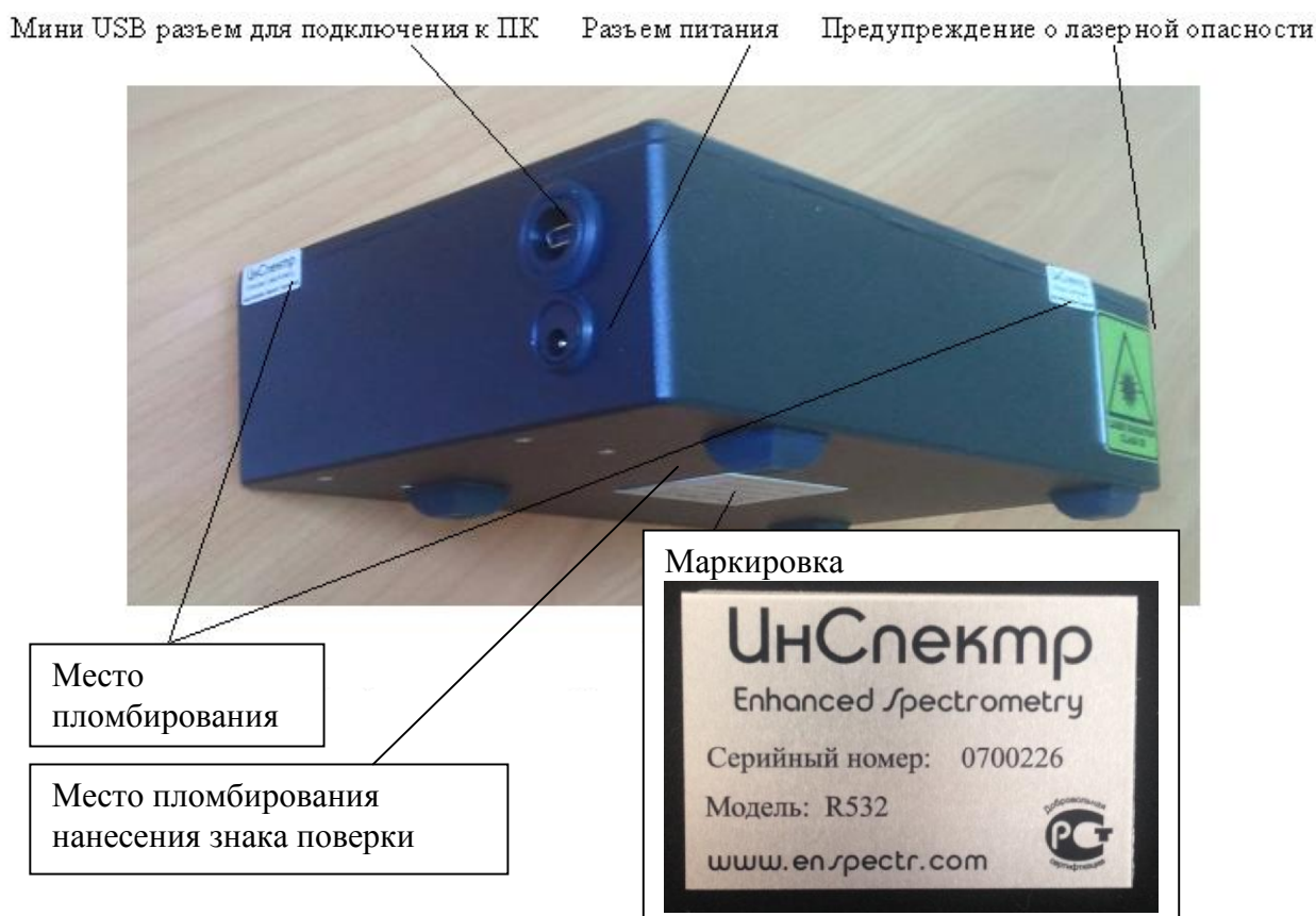
Рисунок 2 - Схема пломбирования, обозначение места нанесения знака поверки и маркировки
