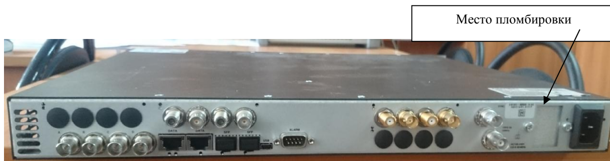
Рисунок 1 - Внешний вид средства измерений, обозначение места нанесения знака утверждения типа и схема пломбировки от несанкционированного доступа
