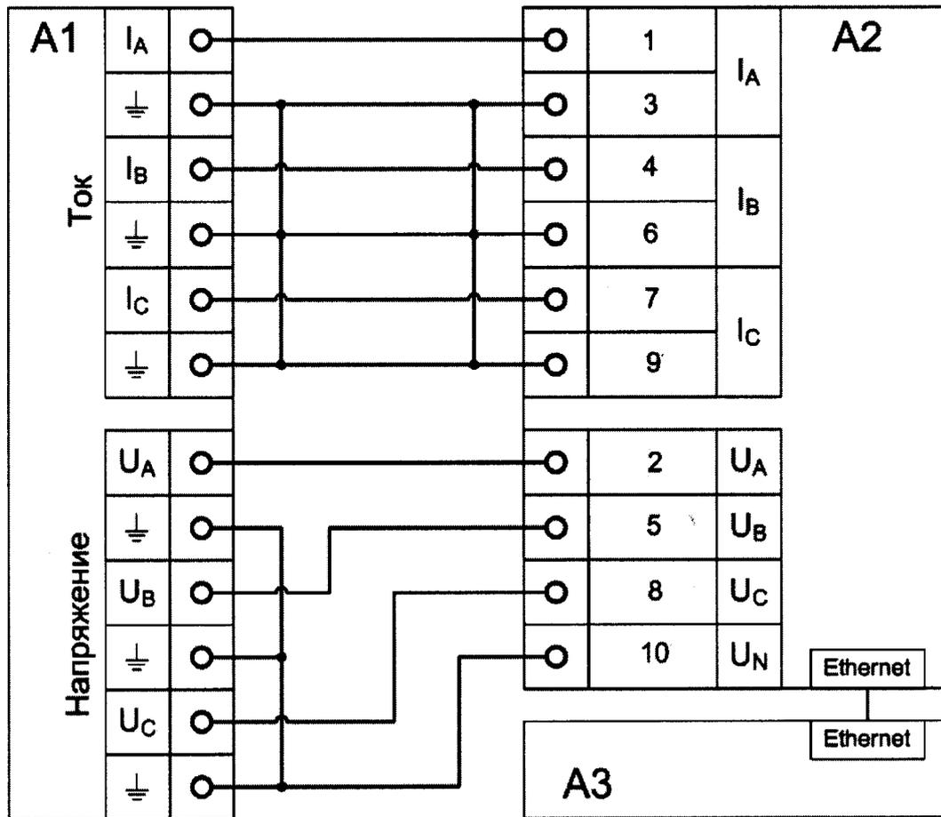
A1 – источник испытательного сигнала (калибратор переменного тока)
