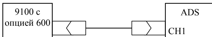
Рис. 2. Структурная схема соединения приборов для определения относительной погрешности коэффициентов отклонения и развертки.
