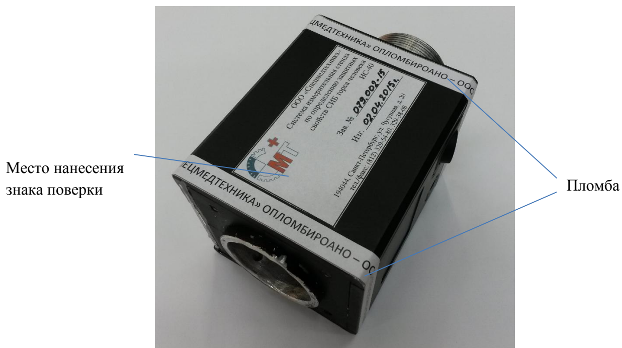
Рисунок 2 - Схема пломбировки от несанкционированного доступа и обозначение места нанесения знака поверки
