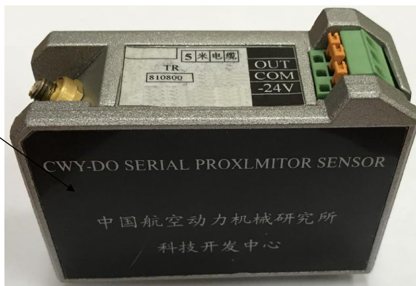
Рисунок 2 - Общий вид вторичного преобразователя модификации TR810800
