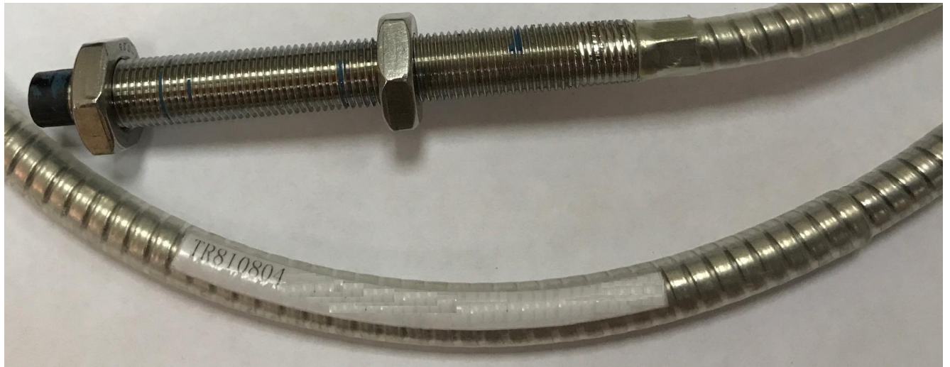
Рисунок 1 - Общий вид первичного преобразователя модификации TR810804
