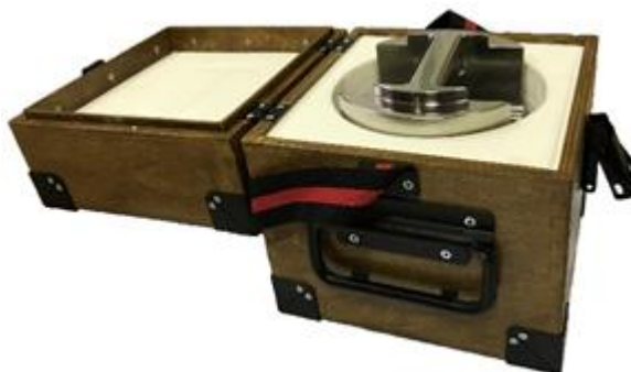
Рисунок 9 – Общий вид гири ГО-П-20 кг Р класса точности F_1 и F_2 , в кейсе
