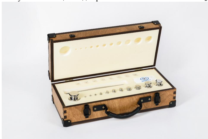
Рисунок 3 – Общий вид набора гирь ГО-ПН класса точности E 2
