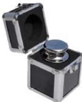
Рисунок 2 – Общий вид гири ГО-П-5 кг класса точности F 2
