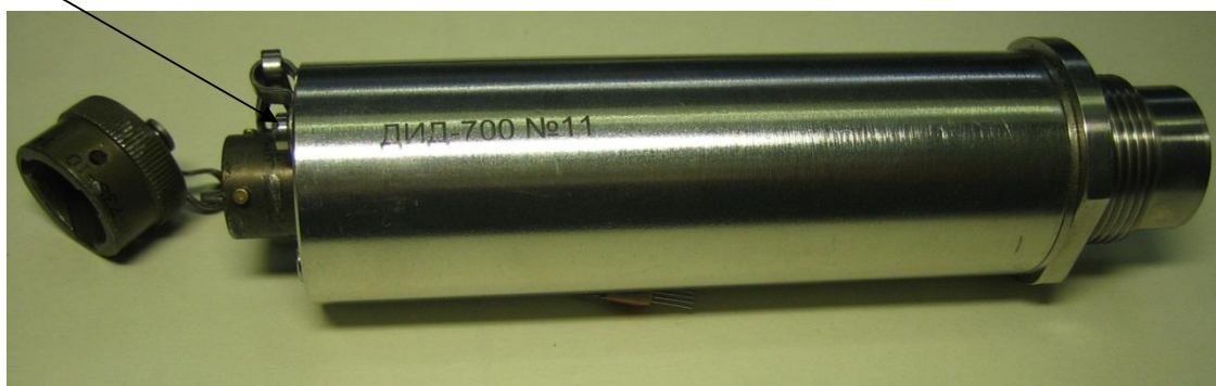
Рисунок 1 - Общий вид датчика с указанием места пломбирования
