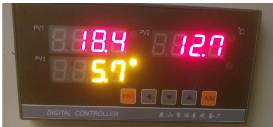
Рисунок 1 - Общий вид измерителя-регулятора температуры цифрового ХМСТ-432А20
