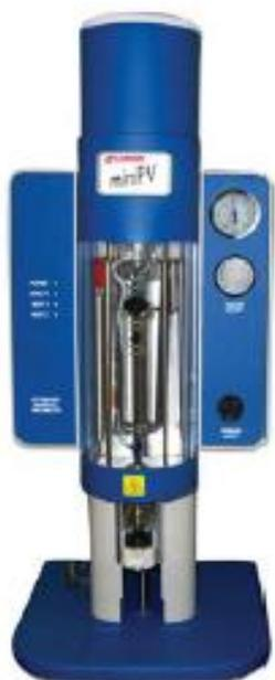
Рисунок 5 - Общий вид вискозиметра модификации miniPV
