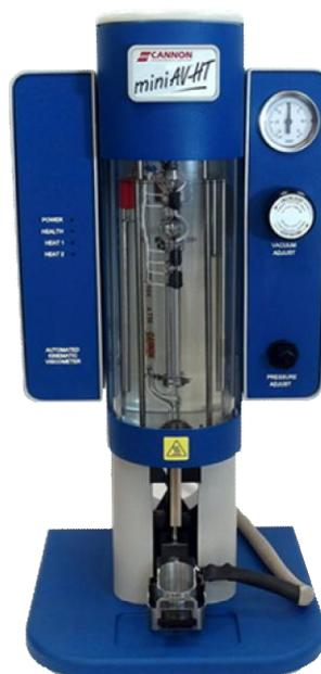
Рисунок 2 - Общий вид вискозиметра модификации miniAV- HT
