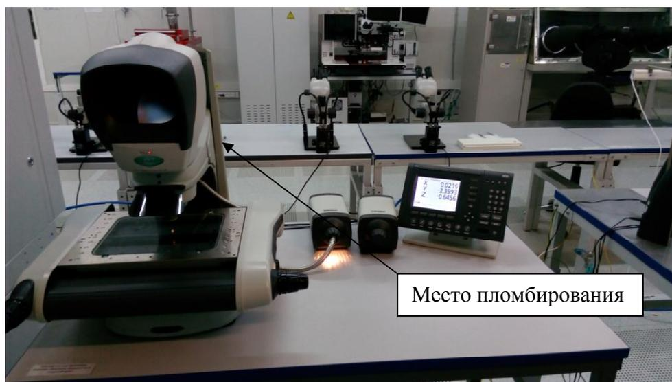
Рисунок 1 - Общий вид системы бесконтактных измерений HAWK/S/7
