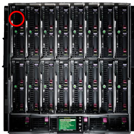
Рисунок 2 - Место блокировки кассетного модуля (выделено)
