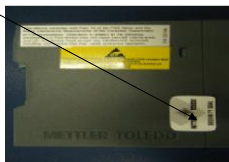
Рисунок 3 - Примеры пломбировки корпуса терминалов
