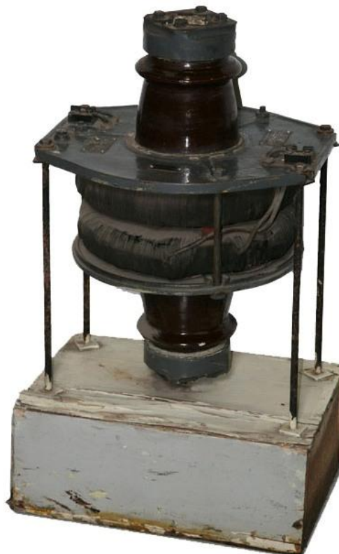
Рисунок 1 - Общий вид трансформаторов тока
