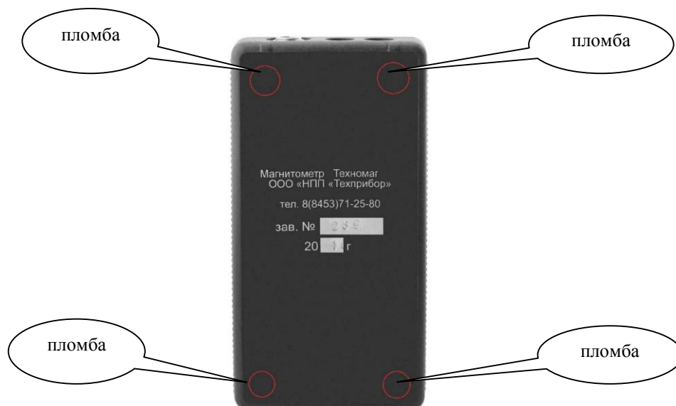
Рисунок 2 – Схема пломбировки от несанкционированного доступа
