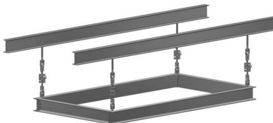
ГПУ (секция) на подвесных узлах встройки датчиков
