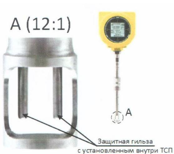
Рисунок 1 - ИМ на примере расходомера с погружным ПП
