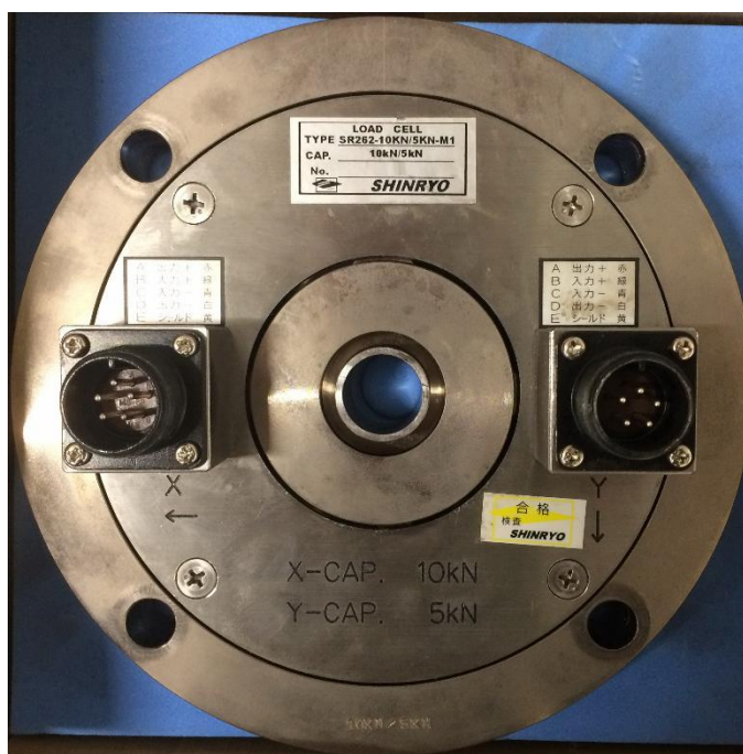
Рисунок 1 - Общий вид датчиков силоизмерительных тензорезисторных SR262-10KN/5KN-M1
