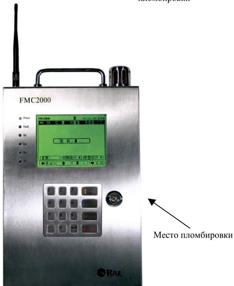
Рисунок 5 - Общий вид контроллера FMC2000 с указанием места пломбировки
