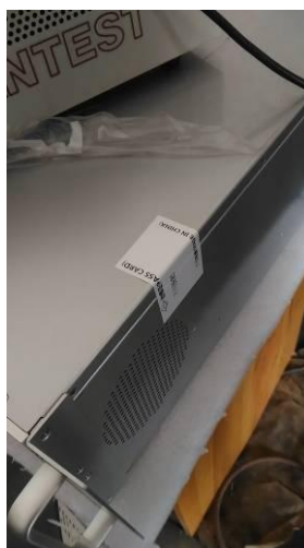
Рисунок 2 - Схема пломбирования от несанкционированного доступа
