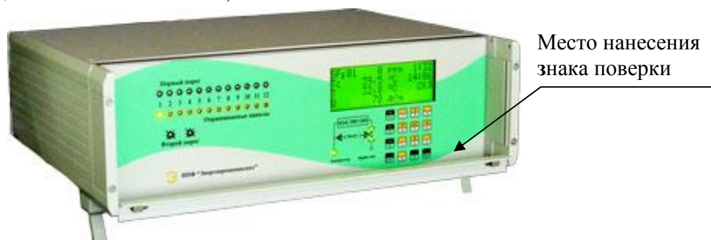
Рисунок 2 - Фотография общего вида газоанализаторов «МАК-2000-UMS» (в 19-ти дюймовом корпусе)
