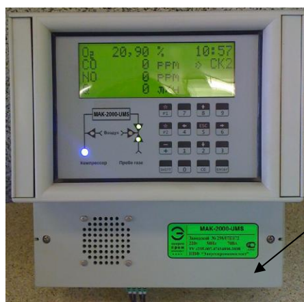
Рисунок 1 - Фотография общего вида газоанализаторов «МАК-2000-UMS» (для настенного монтажа)
