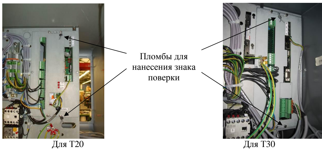
Рисунок 5 - Схема пломбирования крышки электронно-вычислительных устройств T20 и T30
