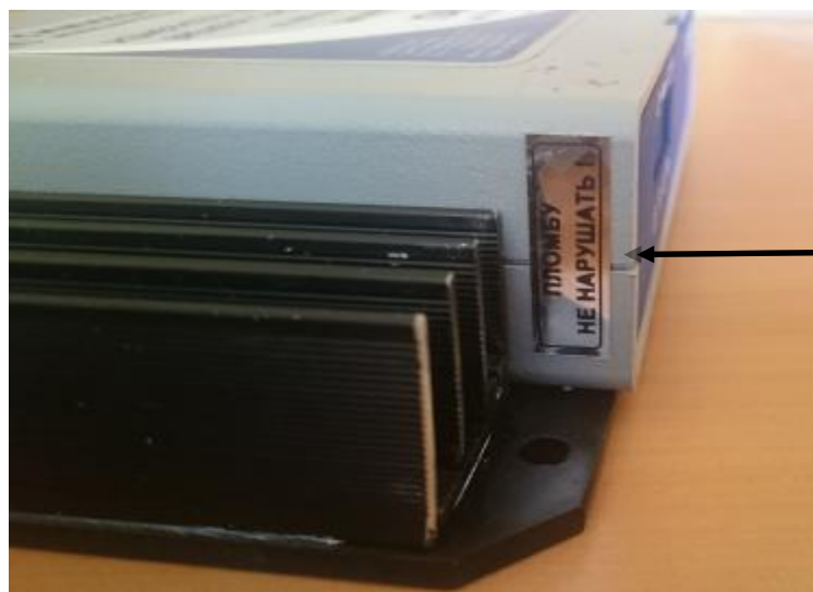
Рисунок 2 - Место пломбировки от несанкционированного доступа
