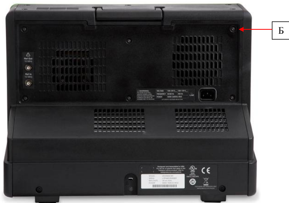
Рисунок 4 – Вид задней панели осциллографов и схема пломбировки от несанкционированного доступа (Б)
