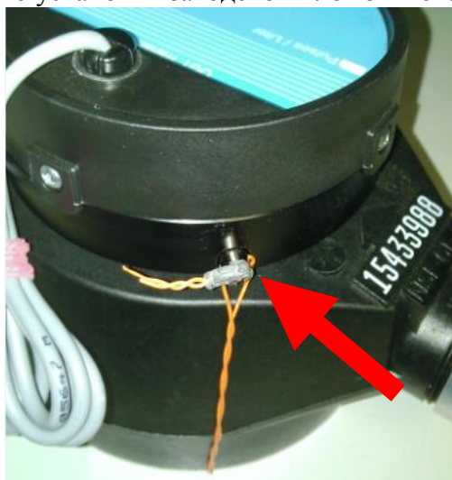
Рисунок 2 - Место установки заводской пломбы
