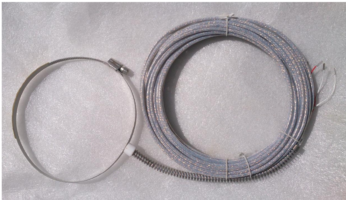
Рисунок 1 – Фотография общего вида термопреобразователя сопротивления платинового поверхностного типа модели 7122
