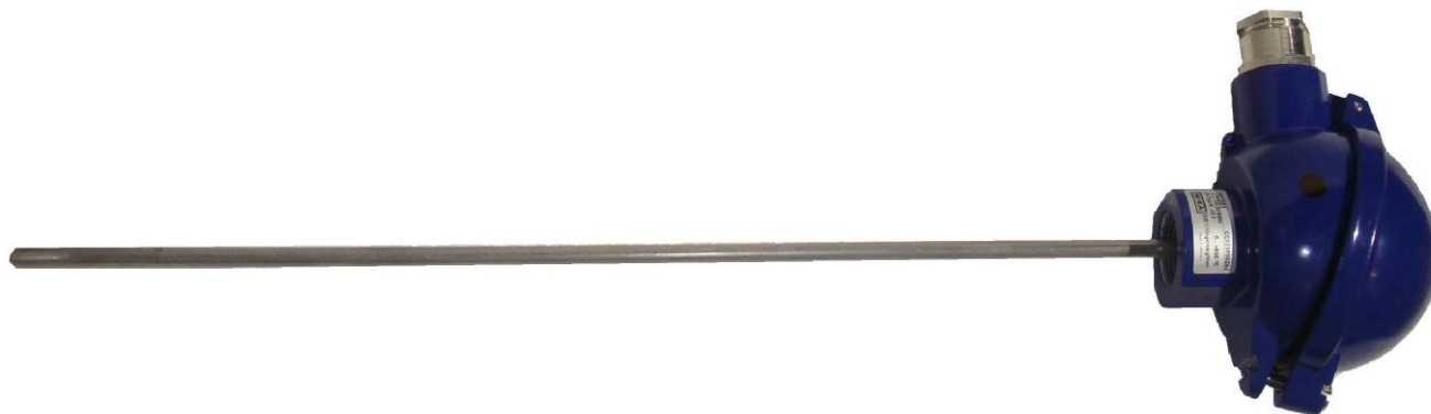
Рисунок 1 – Преобразователь термоэлектрический с двумя термопарами модели ТС201
