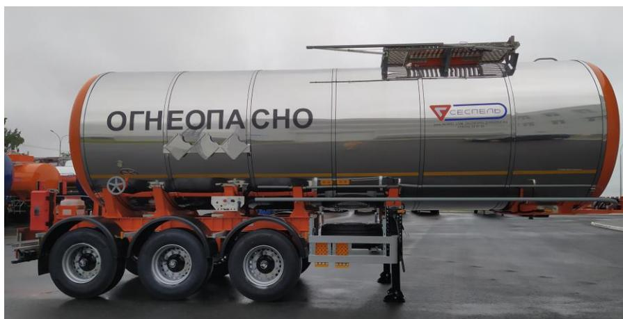
Рисунок 4 - Общий вид полуприцепа-цистерны SESPEL-ППЦ-30 с теплоизоляцией
