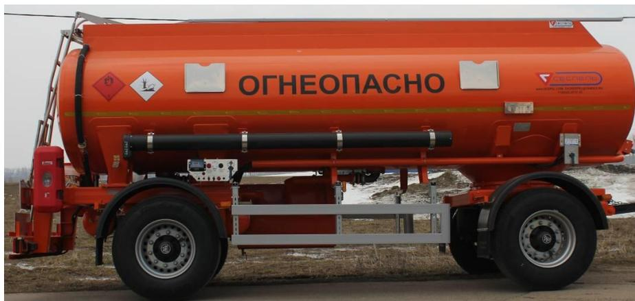
Рисунок 2 - Общий вид прицепа-топливозаправщика SESPEL-ПТЗ-15
