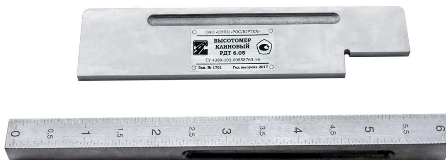
Рисунок 1 – Общий вид высотометров клиновых РДТ 6.05
