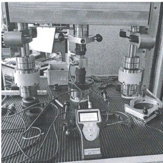
Рисунок 3 – Установка динамометра на сжатие
