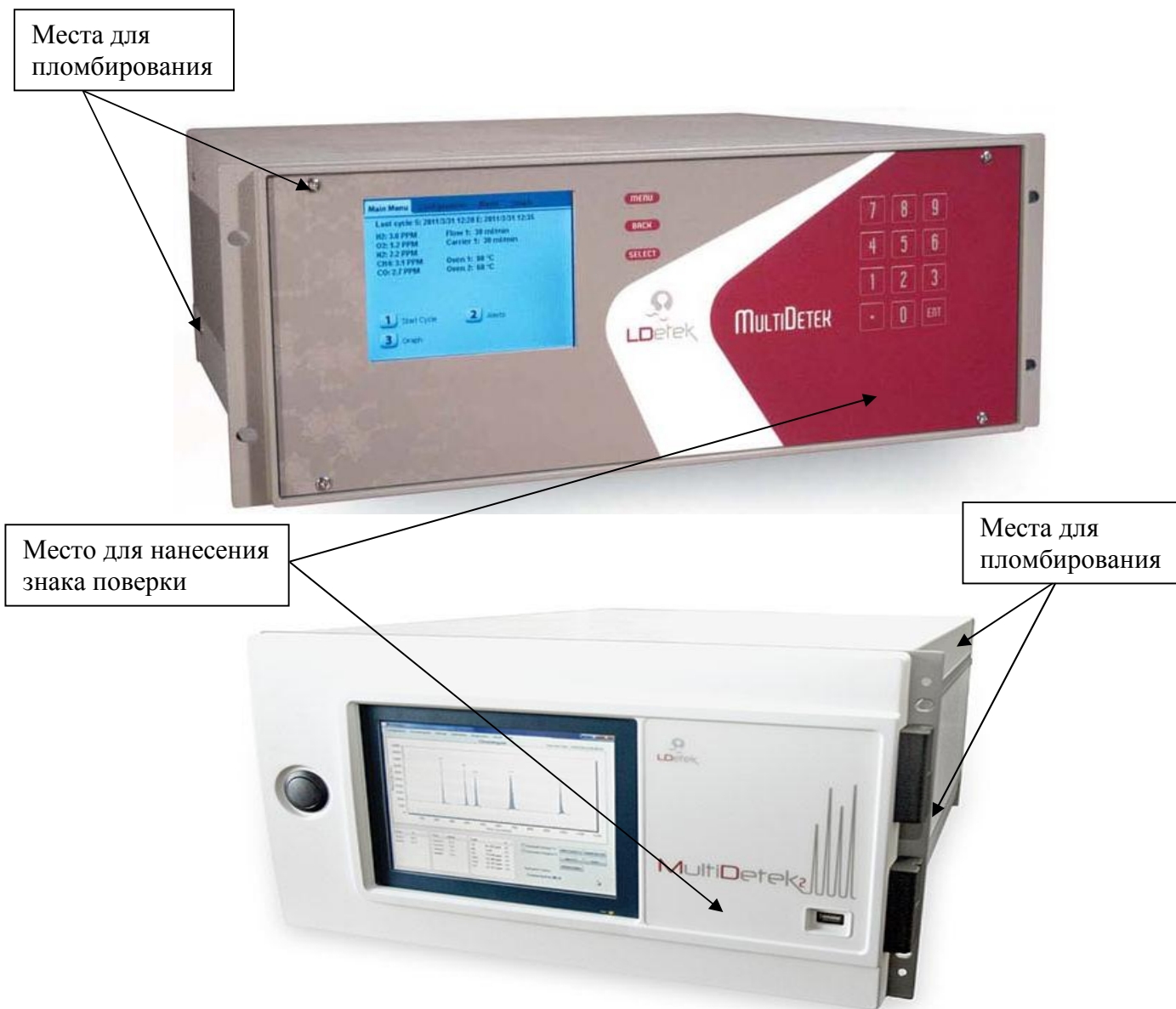
Рисунок 2 - Схема пломбировки от несанкционированного доступа, обозначение места нанесения знака поверки
