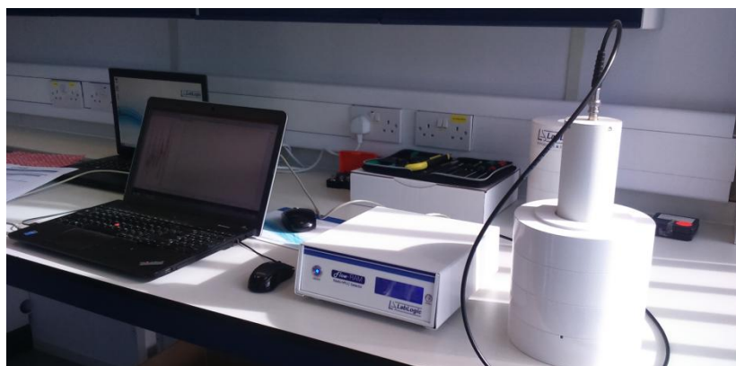
Рисунок 1 - Фотография внешнего общего вида радиометра Flow-RAM
