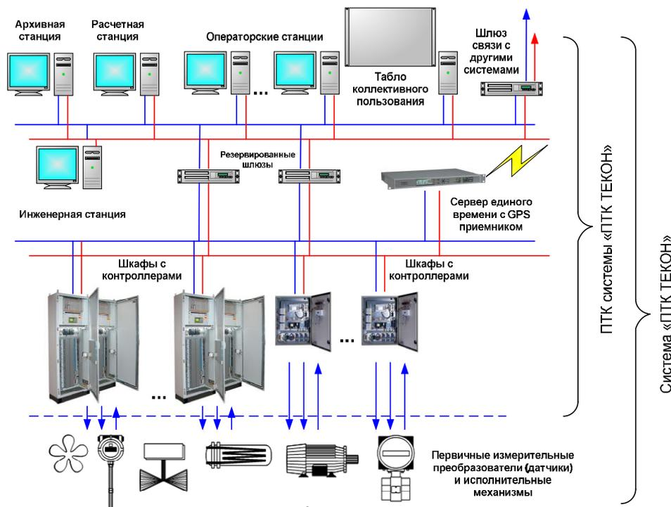
Рисунок 1 — Обобщенная структурная схема систем «ПТК ТЕКОН»
