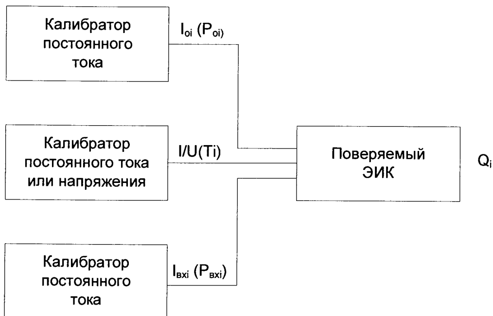
Рисунок 9.8 – Схема соединений при поверке канала ПТК измерения расхода
