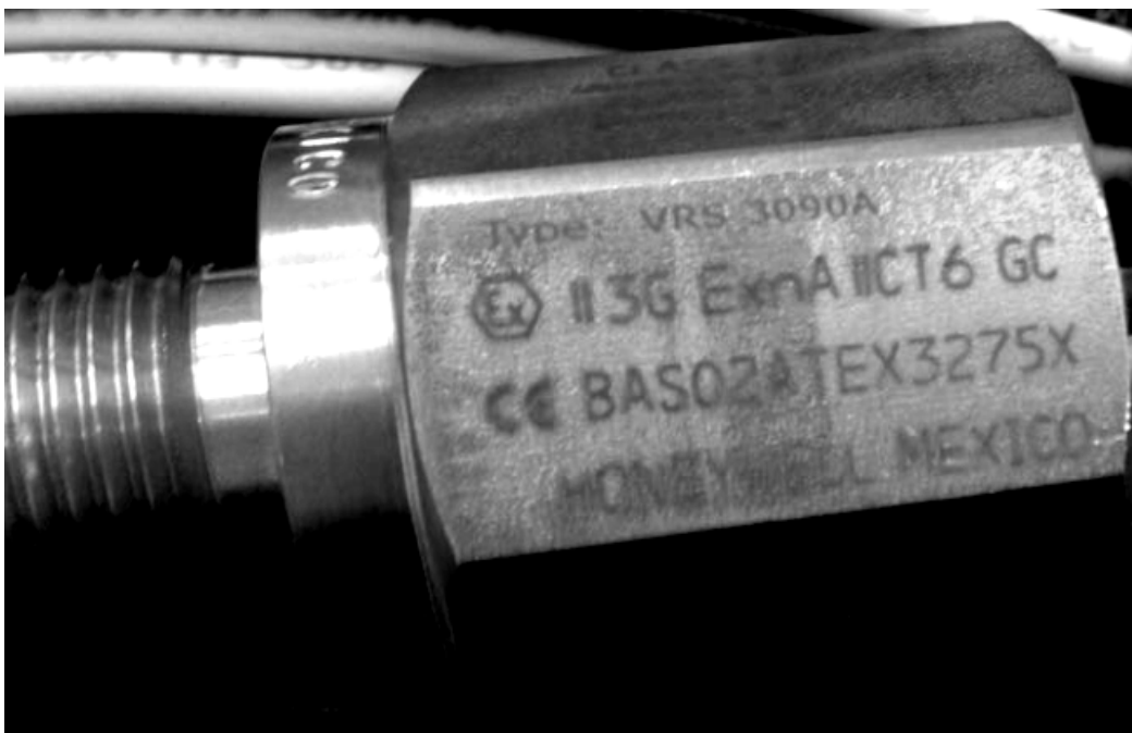
Рисунок 1 – Общий вид датчика частоты вращения VRS модели 3090A
