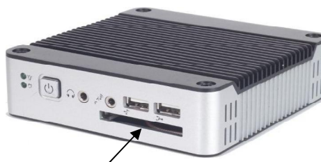
Рисунок 2 - Схема пломбирования вычислительного контроллера
