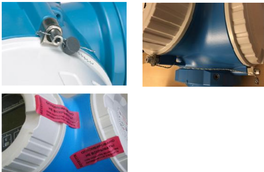
Рисунок 3 - Пломбирование корпуса измерительного преобразователя.
