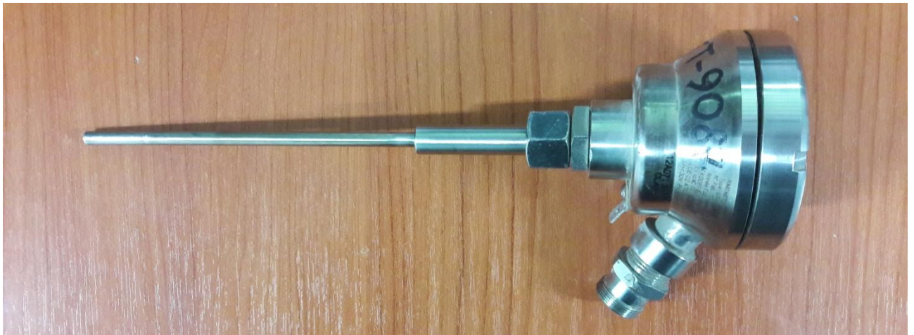
Рисунок 1 - Общий вид термопреобразователя сопротивления платинового с унифицированным выходным сигналом 90.3520/40
