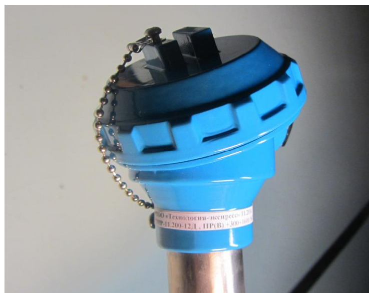
Рисунок 2 - Общий вид ТПП-11.200-14-01Д
