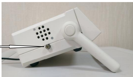
Рисунок 2 - Схема пломбировки от несанкционированного доступа
