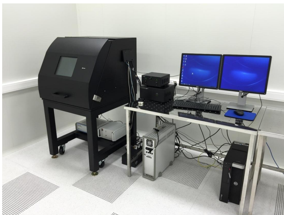
Рисунок 1 - Общий вид микроскопа атомно-силового Keysight 5600LS
