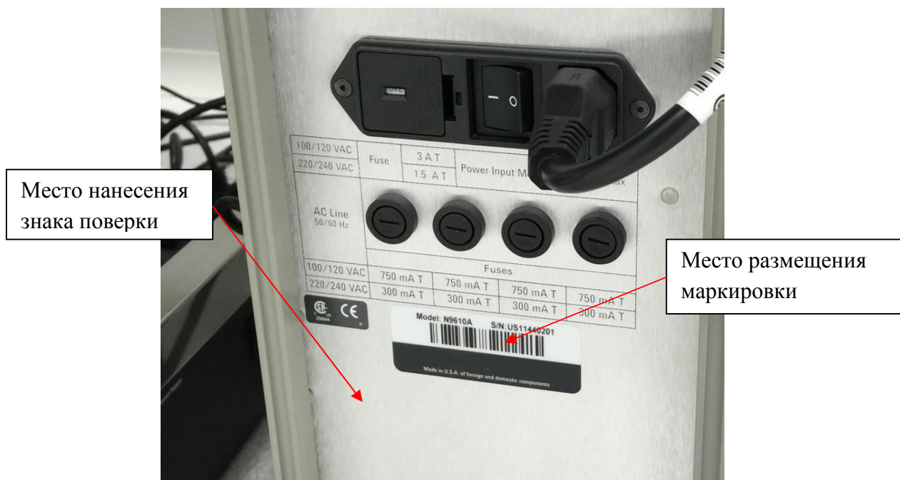
Рисунок 2 - Место размещения маркировки, нанесения знака поверки микроскопа атомно-силового Keysight 5600LS
