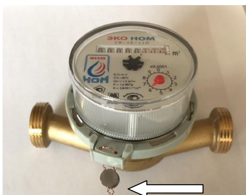
Рисунок 2 - Схема пломбировки от несанкционированного доступа, обозначение места нанесения знака поверки счетчиков холодной и горячей воды универсальных ЭКО НОМ СВ-15
