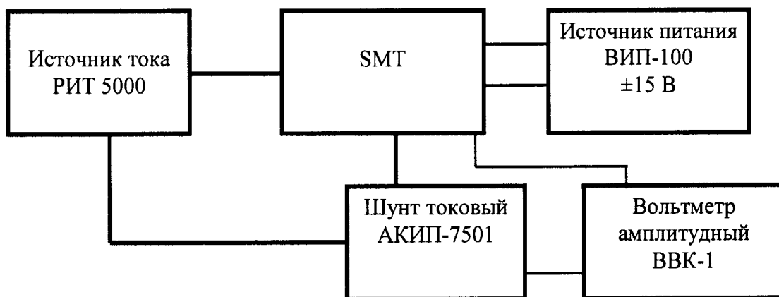
Рисунок 3 - Схема измерения силы тока от 5 до 200 А
