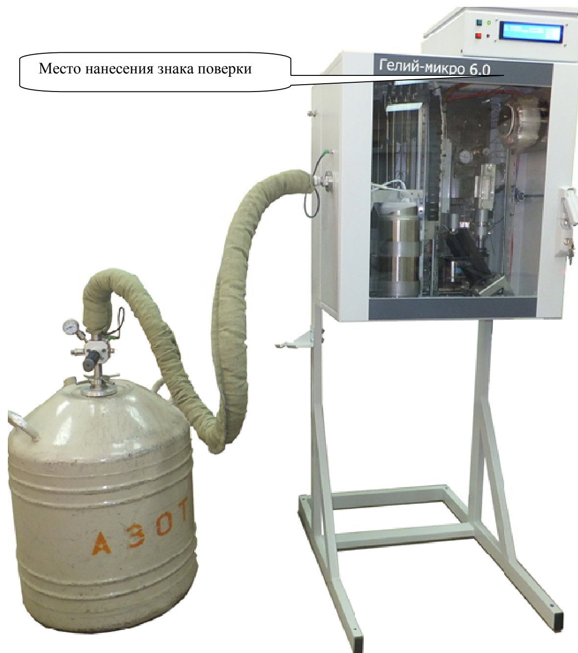
Рисунок 1 - Общий вид криоконцентратора «АСК-2»
