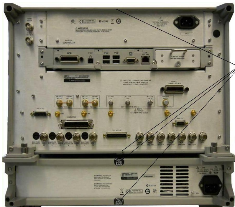
Рисунок 2 - Задняя панель и места для пломбирования анализаторов цепей векторных N5225A с блоками оптического удлинения портов U3020AY03 и U3020AY04
