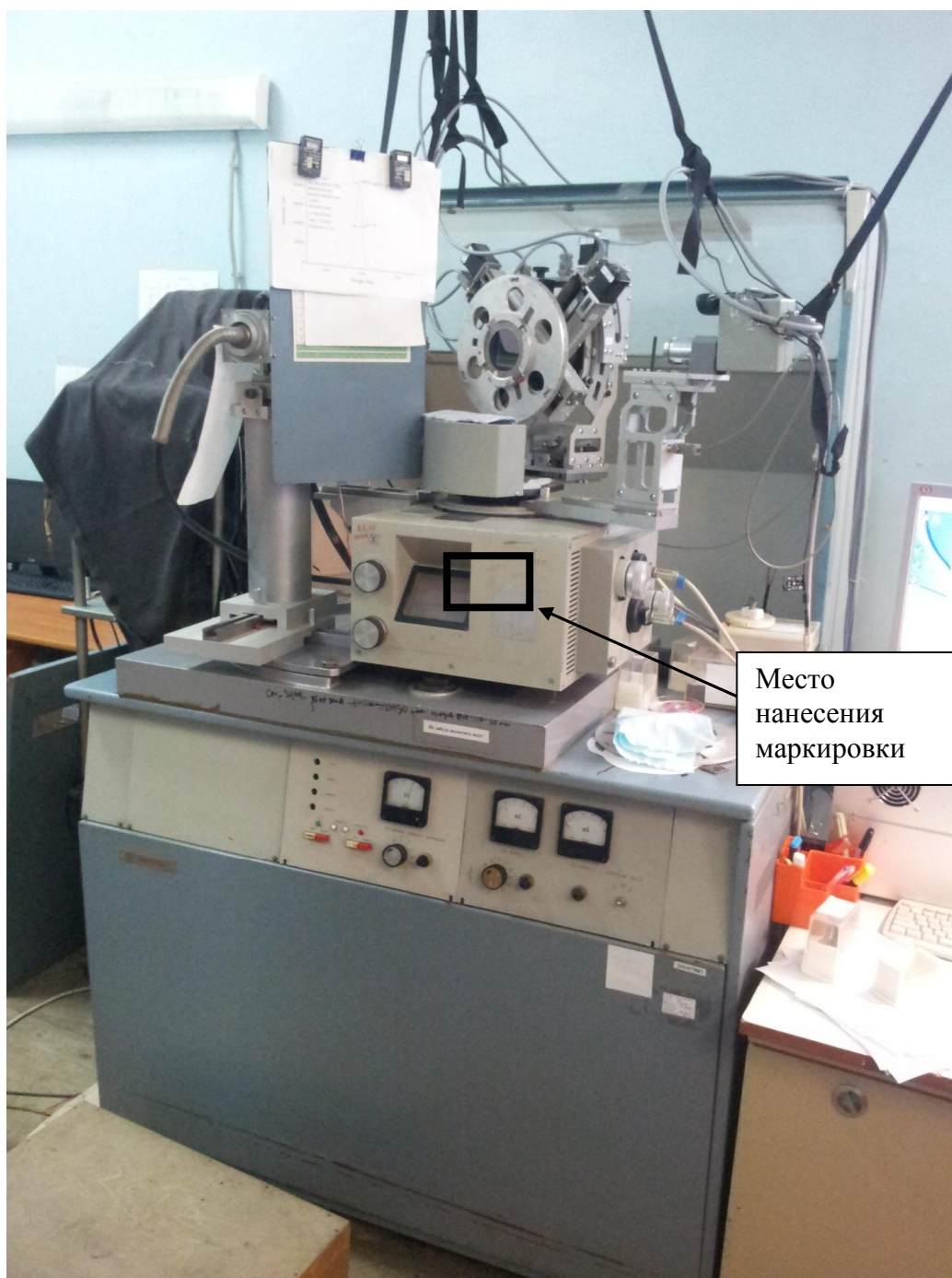
Рисунок 2 - Места нанесения краткого наименования модели, заводского номера, знака утверждения типа, знака поверки
