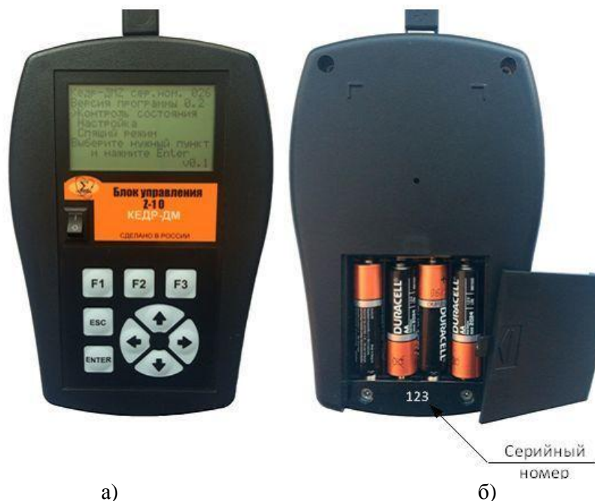
Рисунок 3 - Общий вид блока управления БУ Z-10: а) передняя панель, б) батарейный отсек
