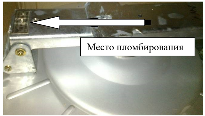
Рисунок 4 - Запорный механизм крышки заливной горловины АТЗ
