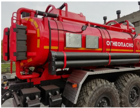
Рисунок 3 - Общий вид АТЗ с системой рекуперации
