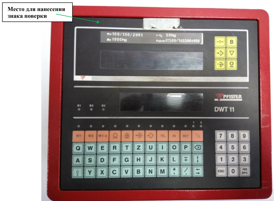
Рисунок 2 - Общий вид терминала весов и обозначение места нанесения знака поверки
