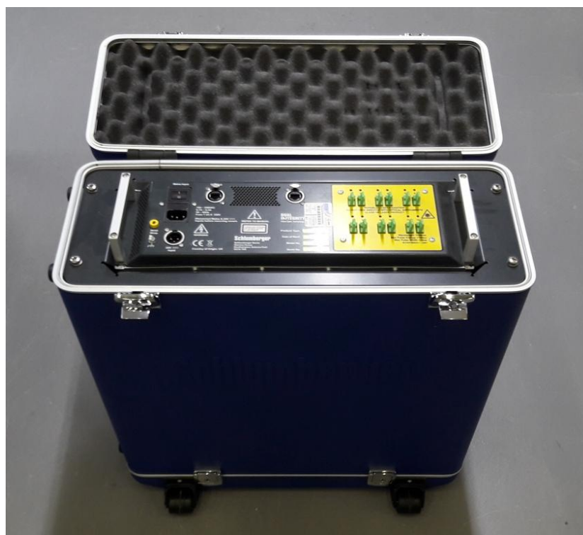
Рисунок 2 - Общий вид измерителей температуры волоконно-оптических распределенного типа DTS модели Sensa Ultra исполнения в твердом переносном кейсе
